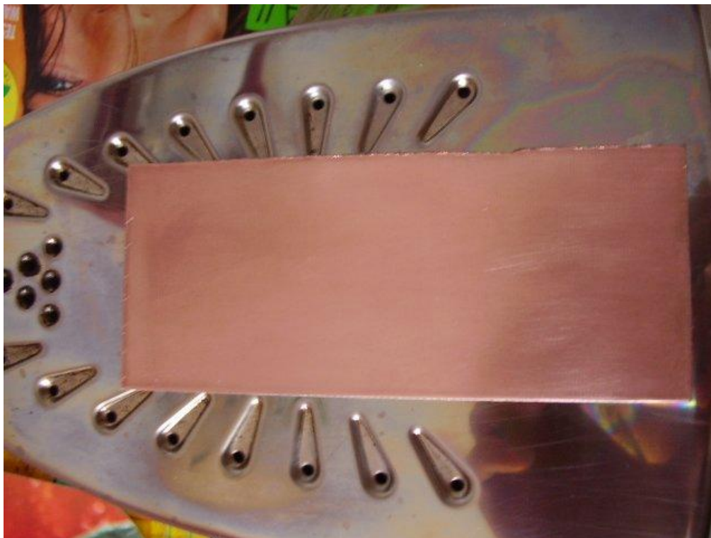
Rys. Ułożenie laminatu na rozgrzanym żelasku.
