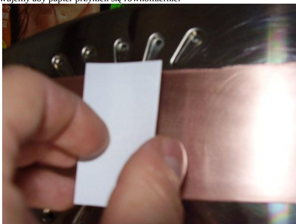
Rys. Przyłożenie papieru z wydrukiem do płytki.
