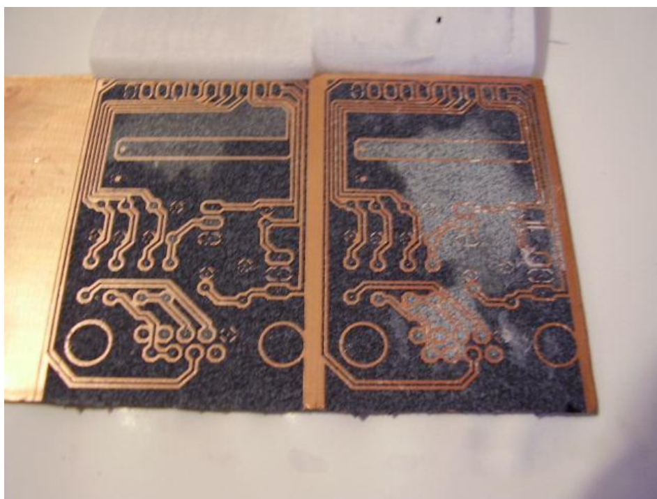
Rys. Ściągnięty papier, toner i kreda na płytce. Jak widać papier odchodzi ale zostaje kreda na tonerze. Resztki papieru trzeba usunąć i ścierać się bardzo łatwo palcem. Większość zaleca dokładne pozbycie się kredy przez pocieranie palcem lub przy użyciu małej ilości CIF'u. Ja proponuje kilka razy potrzeć palcem całą płytkę tak by nie była aż taka biała ale też nie ścierać całkiem aż do czarnego tonera.
