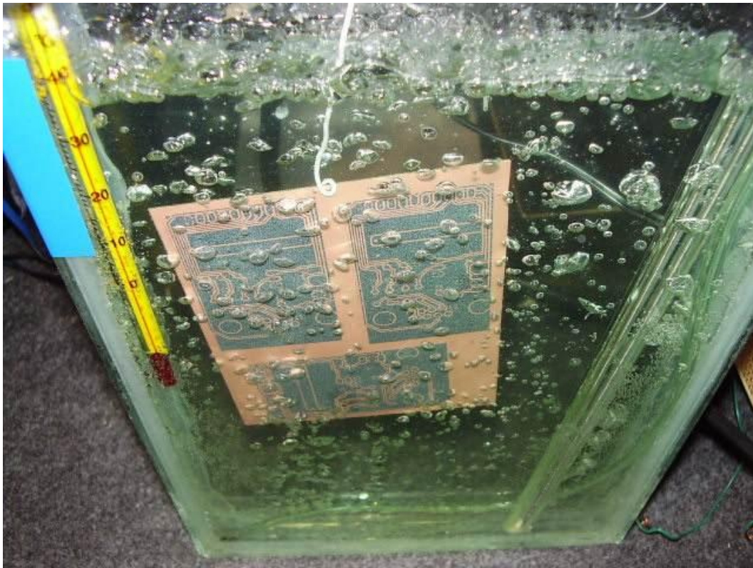
Rys. Trawienie płytki w bąbelkach :)
